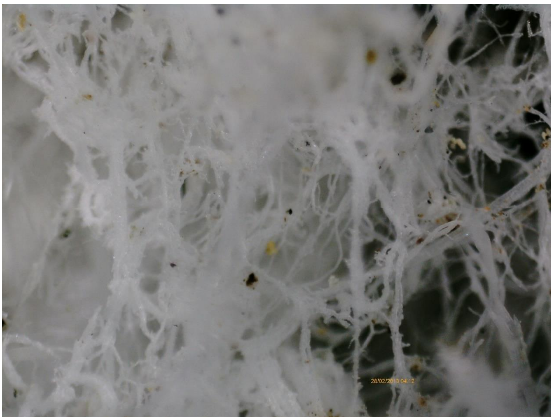
Fot. Nr 43. Widok makro. Pajęczyna włosowato krystalizujących soli na ścianie. Świadczy to o wysokim zawilgoceniu ścian i intensywnym odparowywaniu z nich wody z solami.
